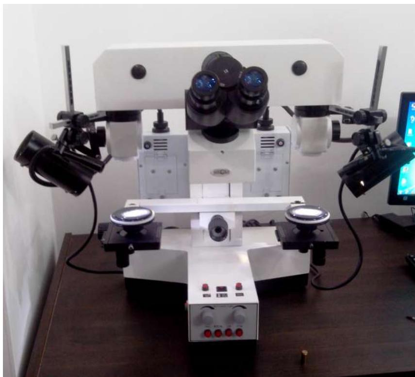
Microscopio balístico marca “Microvisión”.
